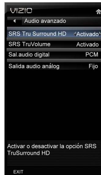
Esta opción configura las propiedades del control de volumen al usar conectores RCA (blanco y rojo) como línea de salida de audio para conectar un sistema receptor/amplificador/teatro en casa. Elija entre Fijo o Variable. Cuando esté configurado a variable, el volumen de las bocinas externas cambiará de acuerdo con el parámetro de volumen en la televisión. Si se configura a Fijo, el volumen solo podrá cambiarse por los parámetros en el sistema estéreo externo.
